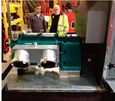
Fig2. XLB-6/2 450 m 3 /h máx 4 bar, motor a diesel IVECO.
