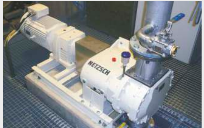
Una Bomba TORNADO® en una fábrica de papel para descargar caolín de Barcos Cargueros. El caudal es de 75 m 3 /h y la presión de 4 bar.
