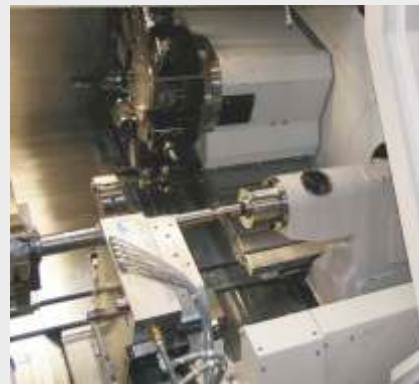
Alta precisión, producción en serie en máquinas de control numérico computarizado (CNC) de 7 ejes (eje motor mostrado)
