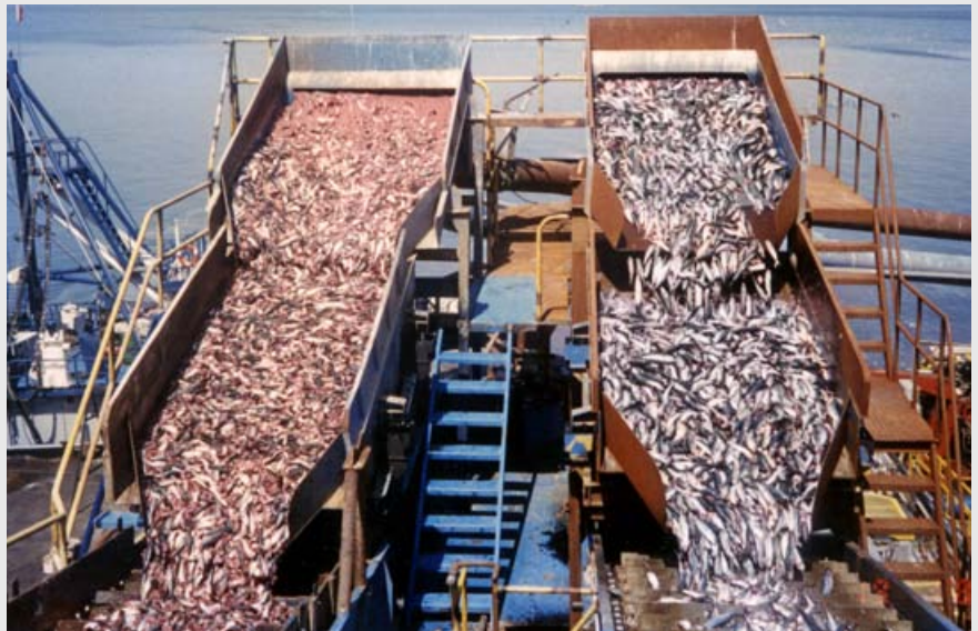
Descarga del pescado: usando bombas de tornillo excéntrico (vista derecha) se producen menores pérdidas y menor contaminación del agua de bombeo con aceite y sólidos, en lugar de bombas centrífugas (vista izquierda).
