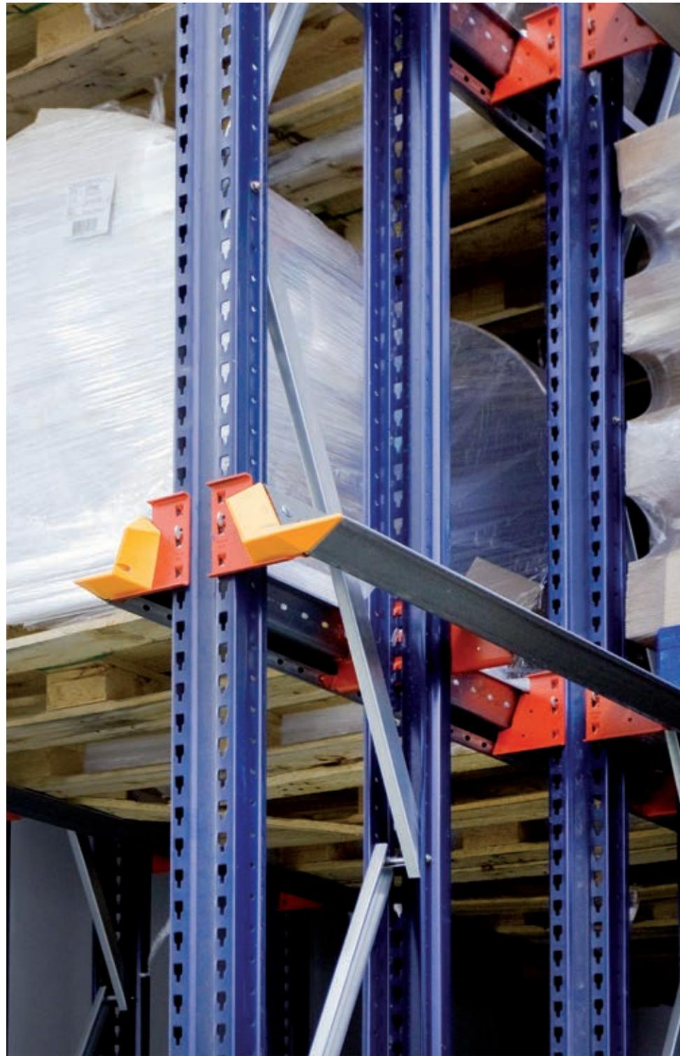
Los puntales utilizados como resultado de dichos cálculos se han desarrollado con geometrías específicas para cada tipo de instalación y cubren todas las necesidades de almacenaje en función de la altura, la carga y la distribución de la instalación (figura 8).
