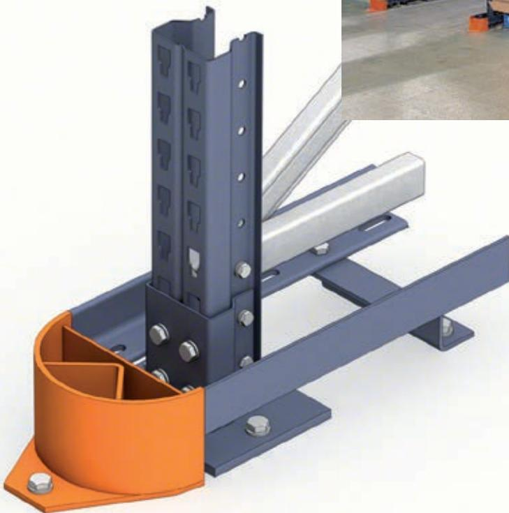
El sistema más usual es el que utiliza perfiles asentados sobre soportes fijados al suelo, con punteras de centraje colocadas al frente de las estanterías. Éstas se unen a los perfiles y también se anclan al suelo.
