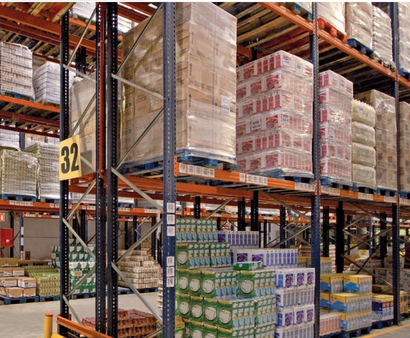
Almacén de paletización convencional con palets manipulados por el lado de 800 mm.
